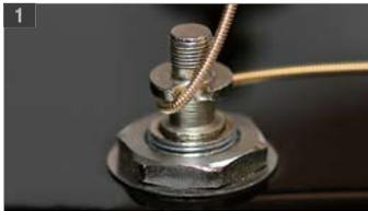
1 ロックナットを回してストリングリセスがネックの方向に対し90度になるようにします。手で糸巻きを回すかストリングアップモードを使用することもできます。
